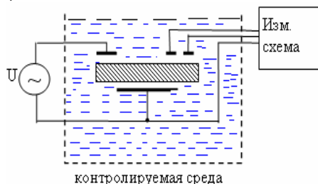
Рисунок 5 – Датчик вязкости на основе дифференциального пьезотрансформаторного преобразователя (МСК)
